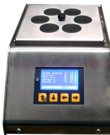
Stazione analisi oli, carburanti e contaminazioni batteriologiche AT08915
