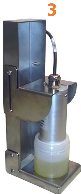
Sensore di analisi qualità prodotto montato su supporto AT15215
