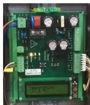
**Kit compensatore di temperatura ATEX.**
